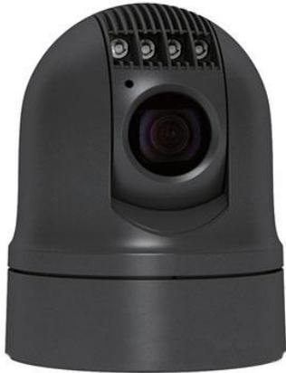
La série VH regroupe des caméras motorisées PTZ durcies pour les véhicules, l'industrie et toute application embarquée mobile de terrain, cette caméra résiste à l'eau et aux vibrations. Avec éclairage blanc ou IR (selon modèles), vous pouvez voir dans le noir complet jusqu'à 60m. La stabilisation d'image intégrée (DIS) permet d'amortir l'effet de vibration à l'écran.
