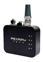
Le range extender PXR permet aux panneaux de se connecter à une tablette ou un ordinateur portable jusqu'à 500 m, avec ou sans fil.
