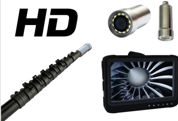
Le système CNDEye HD est une solution prête à l'emploi d'inspection vidéo en milieu non accessible, afin d'éviter les opérations onéreuses de démontage des zones à contrôler. Dotée d'un éclairage blanc par 12 Leds puissantes et d'une caméra étanche le CNDEye HD est une solution polyvalente convenant à la plupart des inspections. Plusieurs perches sont disponibles, de 3m à 10m.
