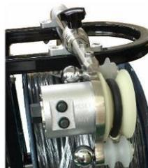
Odomètre intégré avec RAZ
