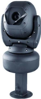
Les Cameras de la serie CV35F sont spécialement conçues pour les applications exigeantes, assujetties aux vibrations et chocs. Dotée d'un caisson en fonte d'aluminium très épais et d'un hublot en verre trempé, sa résistance aux chocs est des plus élevées pour une caméra PTZ.
